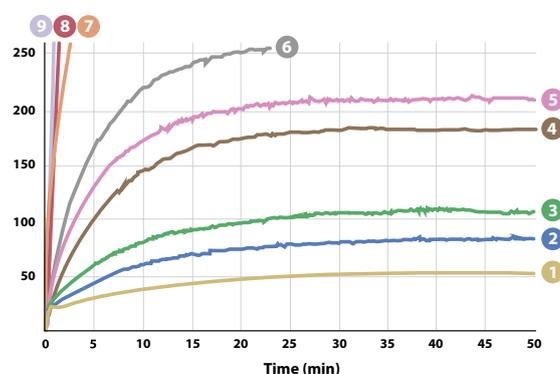
Con la cottura tradizionale a livelli di potenza, una volta selezionato il livello di potenza, il piano cottura eroga una potenza fissa alla pentola; tuttavia, **la temperatura della pentola continua ad aumentare nel tempo**. Questo comporta un controllo limitato del calore e richiede un monitoraggio continuo per garantire una cottura corretta del cibo.
