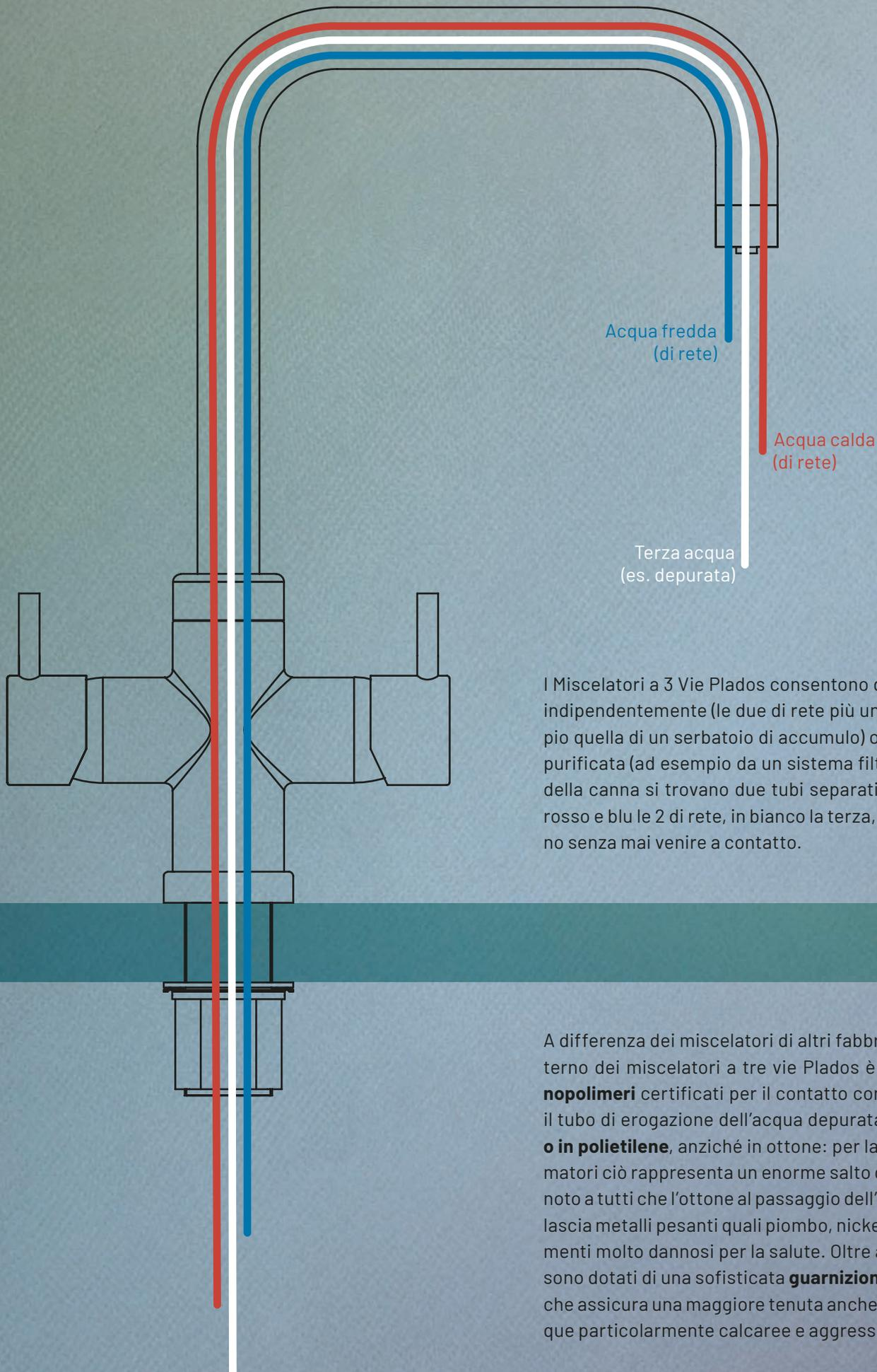
I Miscelatori a 3 Vie Plados consentono di gestire 3 acque indipendentemente (le due di rete più una terza: ad esempio quella di un serbatoio di accumulo) o di gestire l'acqua purificata (ad esempio da un sistema filtrante). All'interno della canna si trovano due tubi separati dove le acque (in rosso e blu le 2 di rete, in bianco la terza, depurata) scorrono senza mai venire a contatto.
